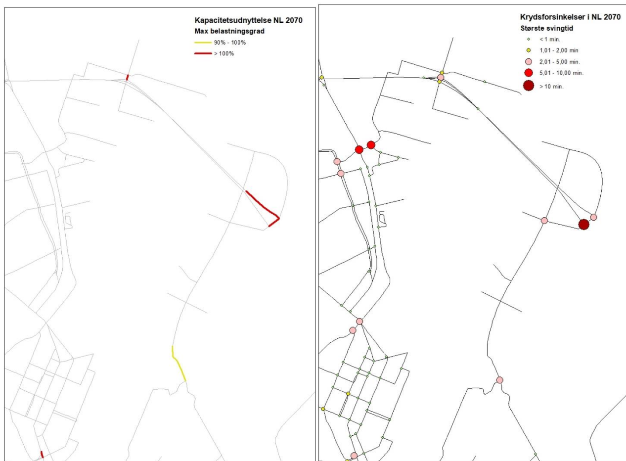
Figur 26 Kapacitetsudnyttelse og krydsforsinkelser i den mest trafikerede time på en normal hverdag i 2070 for Nordhavn-Lynetteholm (Refshalevej åben for gennemkørsel). Figuren til venstre viser trafikbelastningen i den mest trafikerede time på en normal hverdag i 2070 med etablering af Nordhavn-Lynetteholm (Refshalevej åben for gennemkørsel) i forhold til vejstrækningens kapacitet. Figuren til højre viser forsinkelse i kryds i gennemsnit over den mest trafikerede time. Figur 26 viser, at kapacitet overskrides på veje, ramper og kryds i og omkring TSA2.
